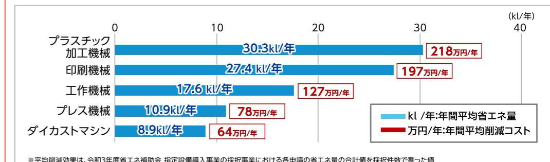
生産設備では、射出成型機等のプラスチック加工機械、印刷機械、工作機械の順で削減効果があります。待機電力の削減や、サイクルタイムの向上等による高効率化を図ることで、エネルギーコストの削減に大きく寄与します。
