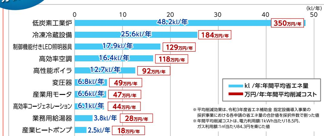
全業種で横断的に使われるユーティリティ設備では、設備特性や事業所で使用する平均台数から、多くの熱量が必要な工業炉、365日24時間稼働が必要な冷凍冷蔵設備、事業所に欠かせない照明や空調、熱供給の汎用設備であるボイラの順で、エネルギー消費効率の高い設備に更新した場合の省エネ効果が高く、エネルギーコストの上昇に抑制効果を発揮します。
